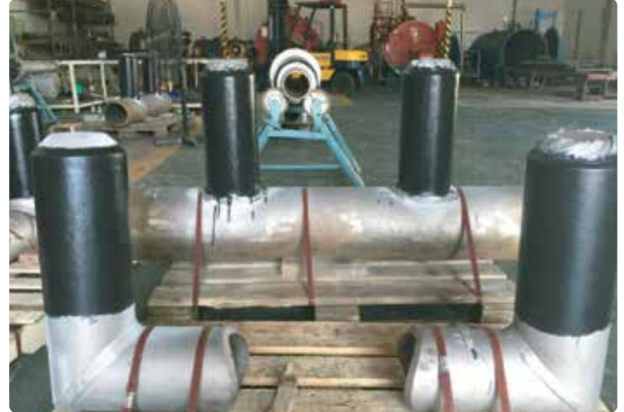
Primer & rubber cement coating
