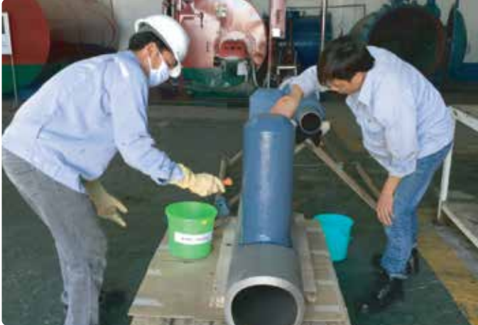
Primer & rubber cement coating
